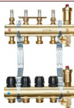
RP-R MagneticAuto rozdzielnica z wkładkami termostaticznymi pod silowniki, rotametrami magnetycznymi, odpowietrznikami automatycznymi i zaworami spustowymi
