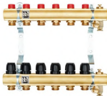
RP rozdzielnik z wkładkami termostatycznymi pod siłowniki, zaworami regulacyjno-odcinającymi, odpowietrznikami i zaworami spustowymi
