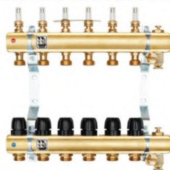
RP-R Magnetic rozdzielnica z wkładkami termostaticznymi pod silowniki, rotametrami magnetycznymi, odpowietrznikami ręcznymi i zaworami spustowymi
